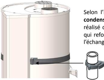
Selon l'humidité de l'air, il peut se former **jusqu'à 0,25l/h de condensats**. L'écoulement de ces condensats ne doit pas être réalisé de manière directe à l'égout, car les vapeurs d'ammoniac qui refoulent de l'égout pourraient endommager les lamelles de l'échangeur de chaleur et les pièces de la pompe à chaleur.
